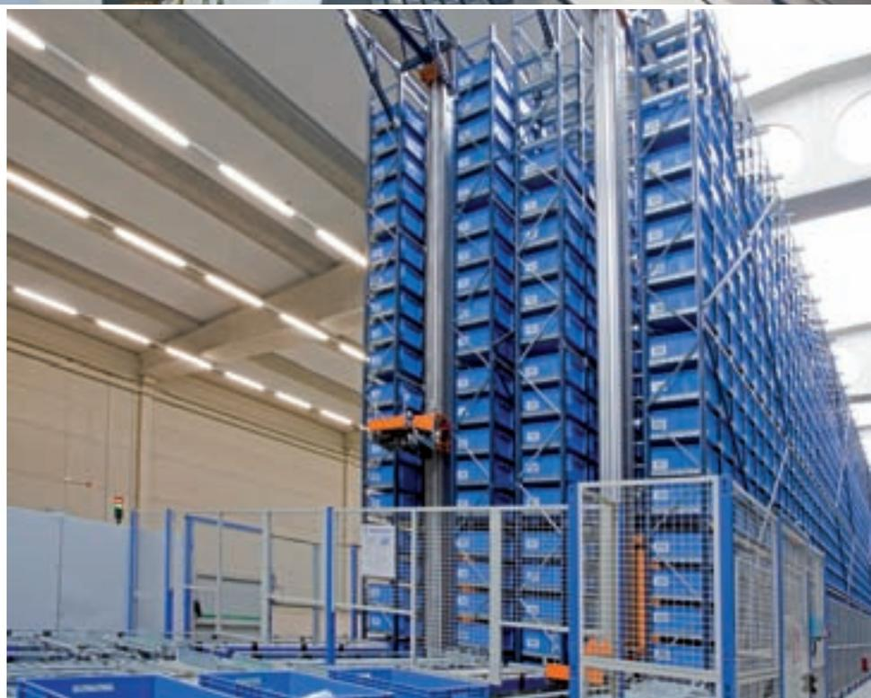
Além disso, os armazéns automáticos para caixas permitem a automatização dos movimentos do armazém, dado que são as máquinas que se deslocam com a mercadoria enquanto o operário se mantém fixo no seu posto. Quanto mais automático e flexível for o posto de picking e mais eficientes forem os dispositivos de ajuda escolhidos, maior será o rendimento obtido.
