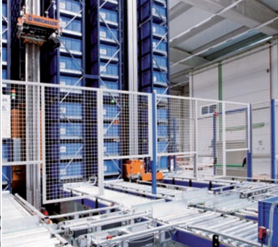
Os postos de picking também podem ser instalados em espaços elevados. Com esta solução, continuam a ser mantidas as vantagens da colocação dos postos de picking em zonas anexas e, além disso, otimiza-se a altura do armazém.
