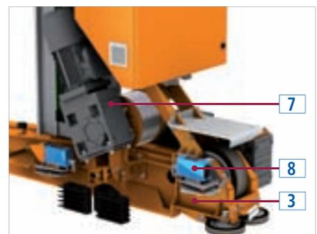
Cabeçote inferior (3), equipamento de elevação (7) e telémetro (8).
