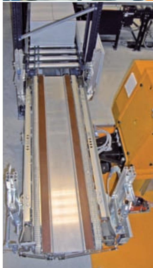
Detalhe do sistema de extracção de pás combinadas com correias (EC).
