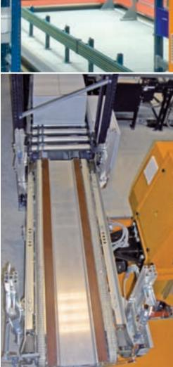
Detalhe do sistema de extracção de pás combinadas com correias (EC).
