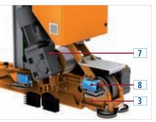
Cabeçote inferior (3), equipamento de elevação (7) e telémetro (8).
