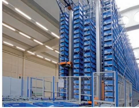
Além disso, os armazéns automáticos para caixas permitem a automatização dos movimentos do armazém, dado que são as máquinas que se deslocam com a mercadoria enquanto o operário se mantém fixo no seu posto. Quanto mais automático e flexível for o posto de picking e mais eficientes forem os dispositivos de ajuda escolhidos, maior será o rendimento obtido.
