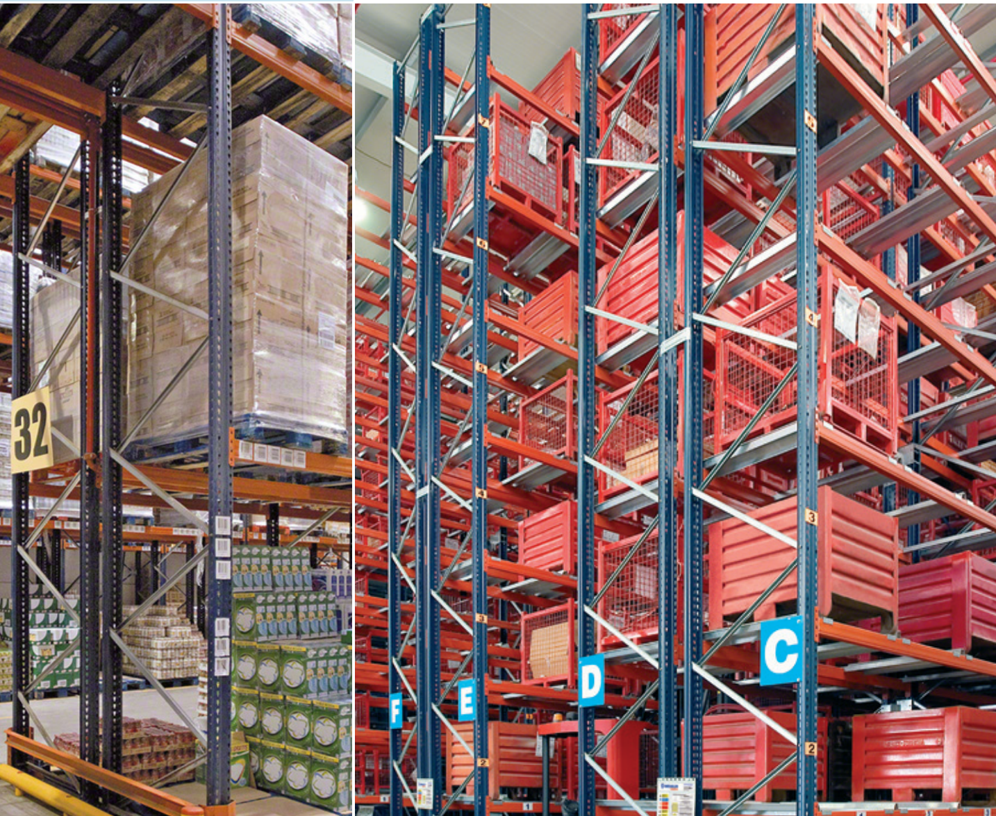
Armazém de paletização convencional com contentores metálicos
