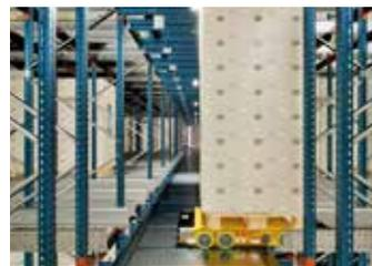
**3.** O carro chega ao canal de armazenagem indicado, levanta ligeiramente a paleta e entra no canal, depositando a carga na localização disponível mais profunda.
