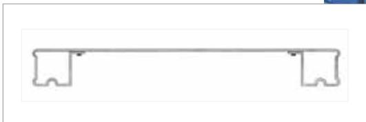
Os níveis podem ser formados simplesmente com prateleiras metálicas, não sendo necessário a colocação de vigas. O tipo de prateleira utilizado é a HM, apoiada nos cantos sobre quatro suportes PK previamente encaixados nos orifícios laterais das colunas.
