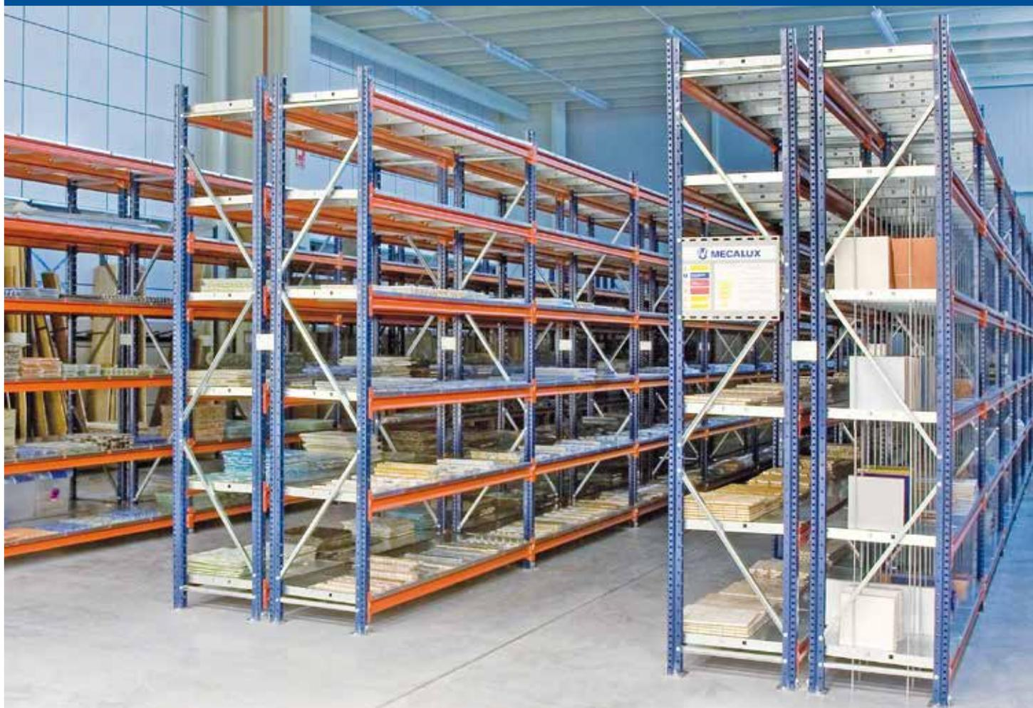
A partir dos diferentes componentes, podem ser realizadas três composições básicas. Os elementos comuns às três são os montantes ou pilares verticais, disponíveis em diferentes modelos, de acordo com a carga a ser armazenada.
