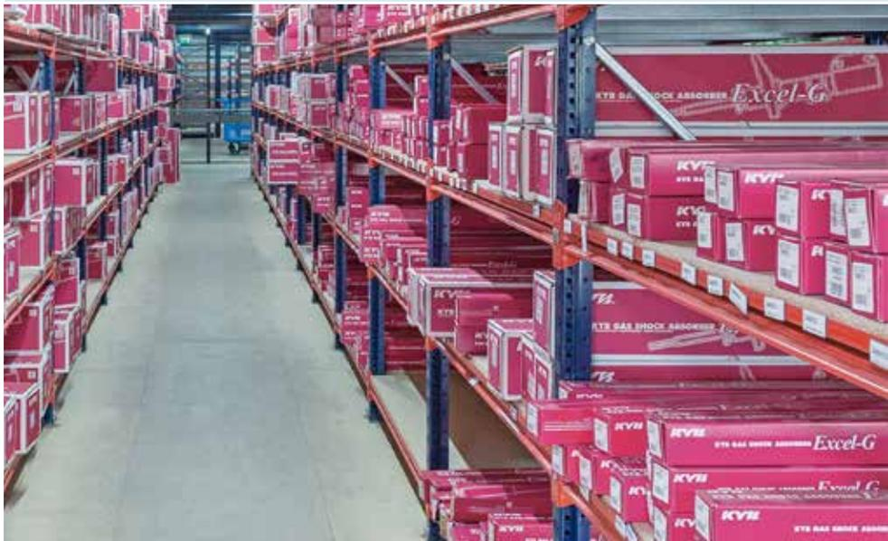
Os sistemas de construção mais utilizados são os que necessitam de vigas e prateleiras para formar um nível e os construídos por prateleiras e suportes.
