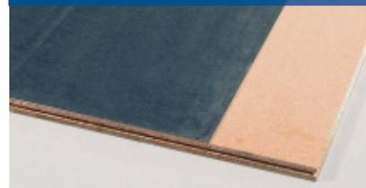
O pavimento de placa de aglomerado de madeira também pode ser revestido com chapa galvanizada de 1,5 mm de espessura para que, quando circule na plataforma algum tipo de porta-paletes ou carro pesado, seja possível evitar o desgaste da placa, bem como minimizar o ruído da deslocação.
