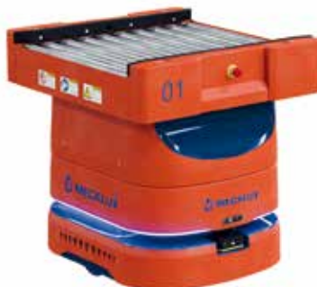
AMR 100 Box com transportador de carga lateral para uma caixa de 600 mm de largura.
