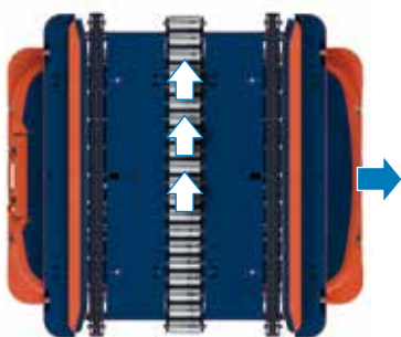
Transmissão de cargas lateral para europeletes de 800 x 1.200 mm.
