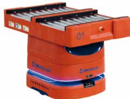
AMR 100 Box com transportador de carga lateral duplo de transmissão dupla para caixas de 400 mm de largura.
