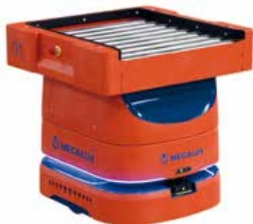
AMR 100 Box com transportador de carga frontal para uma caixa de 600 mm de largura.
