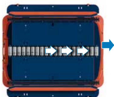
Transmissão de cargas frontal para europeletes de 1.000 x 1.200 mm.
