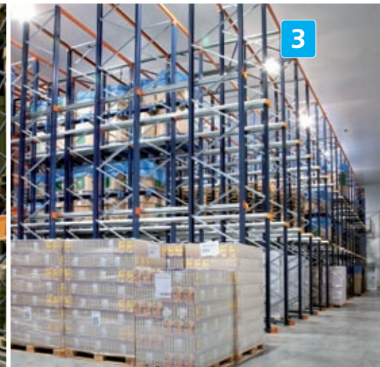
As estantes compactas permitem armazenar produtos monorreferência e que ficarão armazenados por um longo período de tempo.
