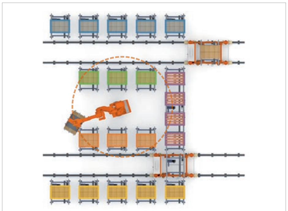
Esquema do funcionamento do sistema com picking automático e robô despaletizador.
