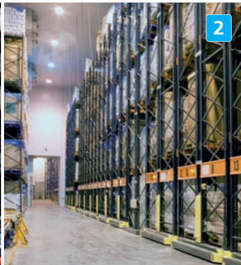
Nas estantes sobre bases móveis armazenam-se os pedidos de média rotatividade ou com paletes de medidas variáveis.
