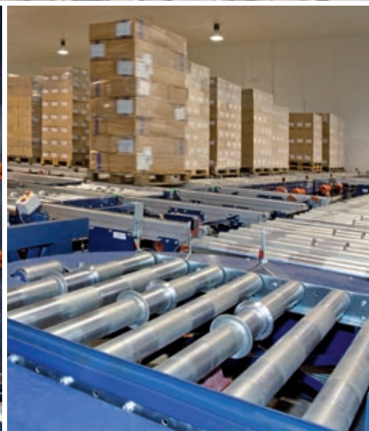
Transportadores de zona de pré-carga.
