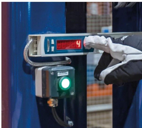
O dispositivo luminoso (*put-to-light*) mostra o número de referências que devem ser colocadas em cada paleta. Uma vez completado o processo, o operador pressiona o botão para informar o SGA. Esse sistema proporciona uma grande agilidade à operação, reduz os erros na preparação de pedidos e permite atualizar o stock em tempo real graças à transmissão de todas as informações ao SGA.
