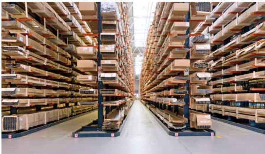
São formadas basicamente por perfis verticais (colunas) e perfis horizontais (bases), colocados como suporte para proporcionar estabilidade, além de braços salientes nos quais se deposita a carga.
