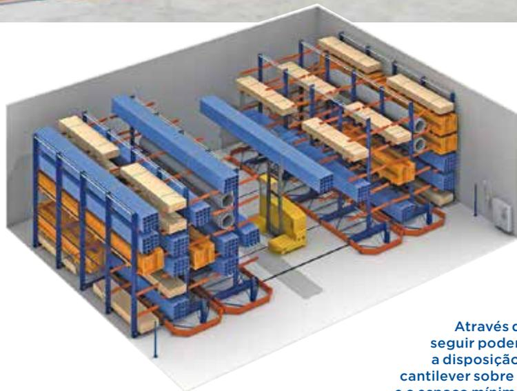
Através das imagens a seguir podemos observar a disposição das estantes cantilever sobre bases móveis e o espaço mínimo de corredor necessário para manobrar o empilhador.
