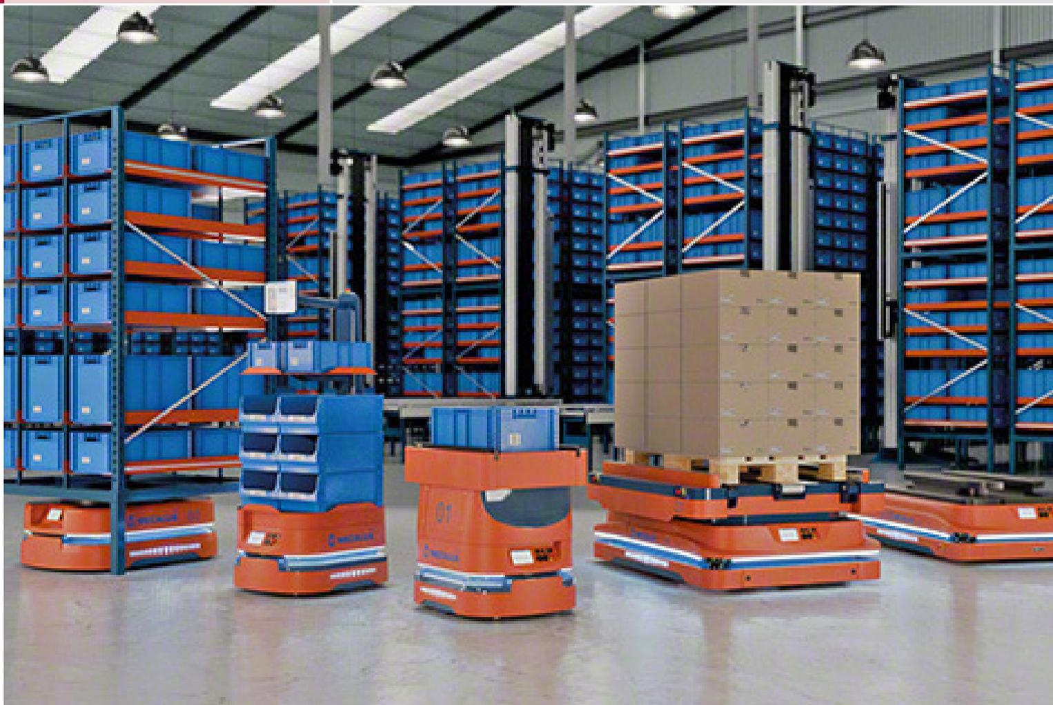
Veículos projetados para transportar cargas entre dois pontos de forma totalmente independente. Navegam livremente no armazém a partir de rotas dinâmicas geradas por um software inteligente que otimiza os seus movimentos e atribui a trajetória perfeita para cada tarefa. Graças à utilização de sensores e scanners de última geração, são capazes de identificar e evitar obstáculos e de operar com segurança em ambientes colaborativos junto de pessoas e de outras máquinas.
