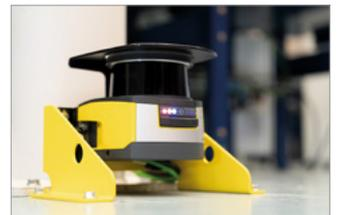
**Rotoscan.** Scanner a laser que permite detetar a presença de um operário na área de operação do robô e ativar o modo de trabalho reduzido. Dessa forma, abranda a velocidade do cobot para que a presença humana à sua volta seja segura.
