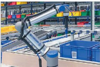
**Braço.** Braço robótico compacto de alto rendimento com dispositivo de prensão integrado na extremidade. Oferece uma grande eficiência operacional e um longo alcance que pode chegar a 1.300 mm.
