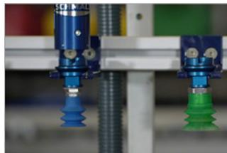
**Dispositivo de prensão.** Garra a vácuo versátil e leve que se adapta a artigos com diferentes formas, superfícies, pesos e dimensões. Garante uma perfeita sustentação do produto, bem como uma delicada manipulação.
