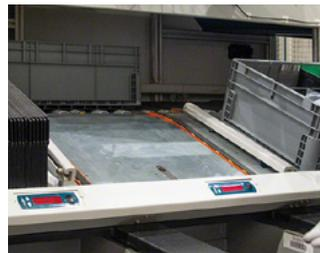
3. Depois de extrair todos os produtos necessários, as caixas da parte superior da estação de picking são automaticamente removidas e regressam ao armazém.
