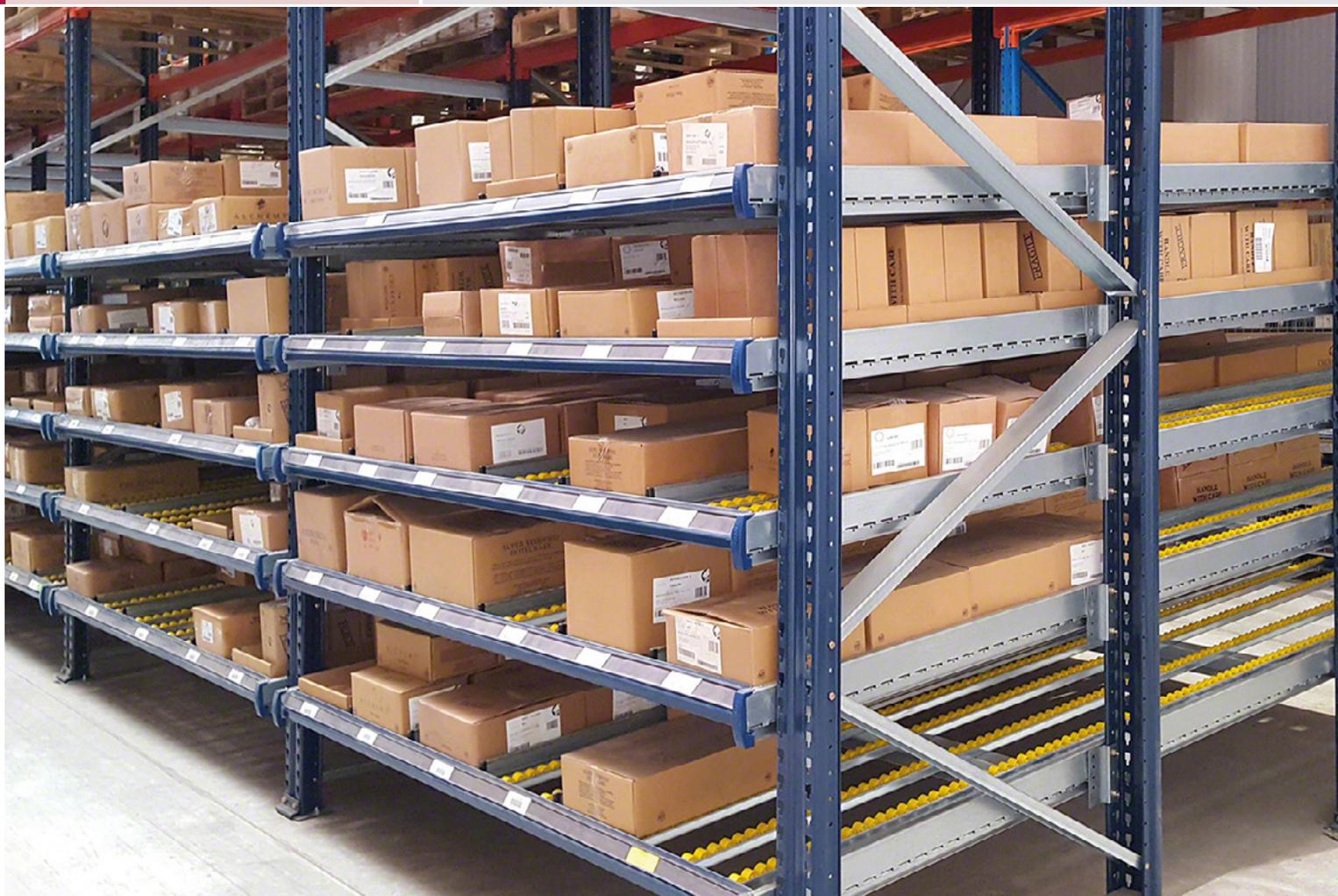
Nas estantes para picking dinâmico, a mercadoria é armazenada sobre plataformas de roldanas ou rolos, desenhadas num plano inclinado de modo a que a mercadoria introduzida por um lado se desloque por gravidade até o lado contrário, que dá para o corredor de saída.
