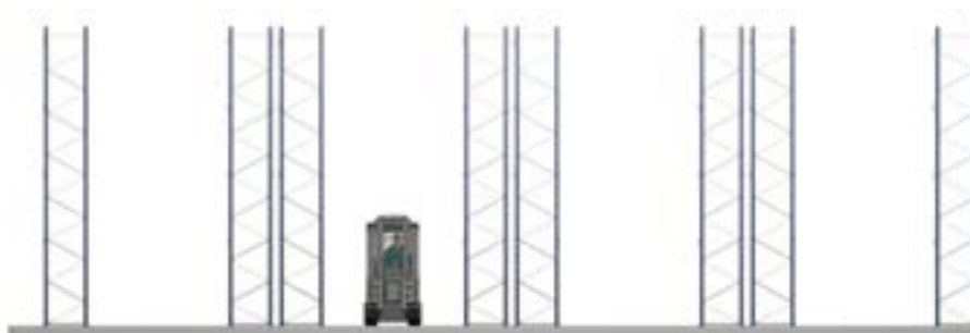
Sistema convencional mais comum, formado por uma estante simples encostada à parede e por estantes centrais duplas
