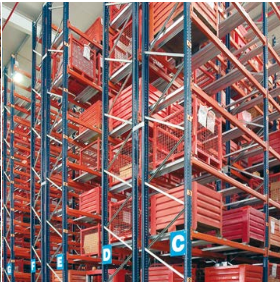
Armazém de paletização convencional com contentores metálicos
