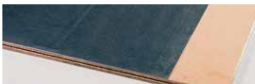
Piso de madeira mais chapa metálica
