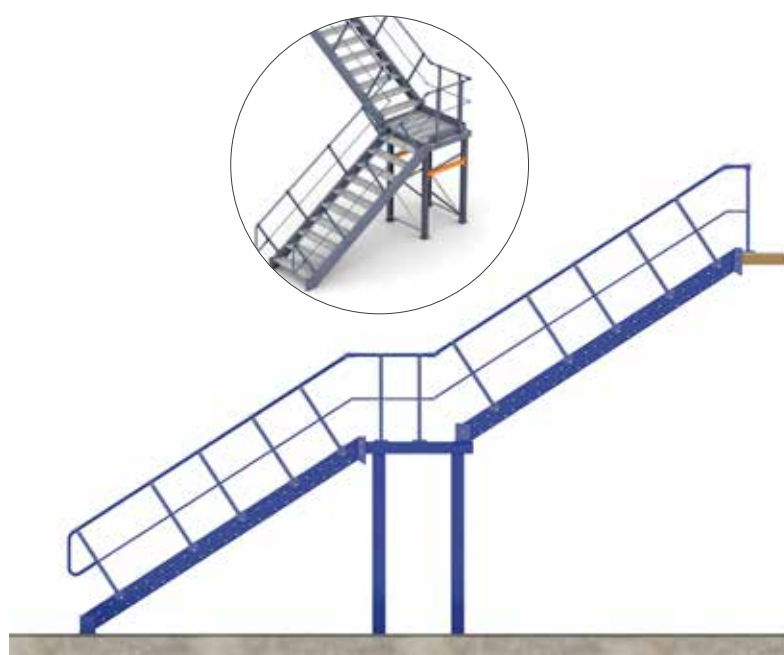
Escadas com patamar (escada contínua com patamar)
