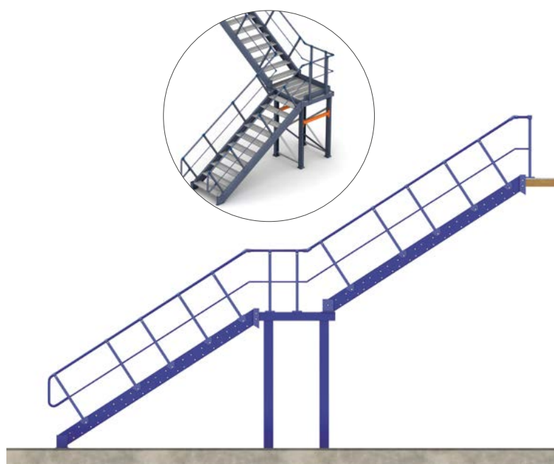
Escadas com patamar (escada contínua com patamar)
