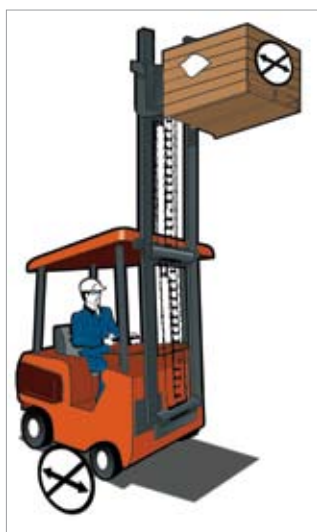
Figura 1 Não circular com cargas elevadas.
