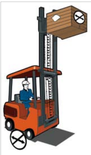
Figura 1 Não circular com cargas elevadas.
