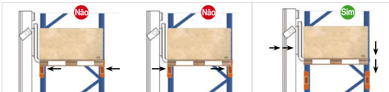
Figura 10 Giro da viga por arrasto ou impulso.
