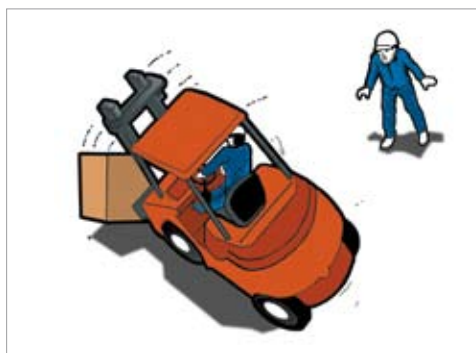
Figura 8 Perda do controlo do empilhador.
