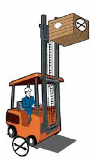
Figura 1. Não circular com cargas elevadas.
