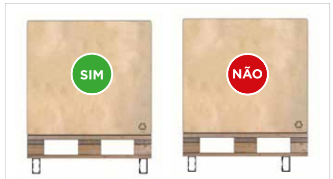
Centralização lateral. A paleta deve ficar centralizada sempre entre as vigas de apoio.
