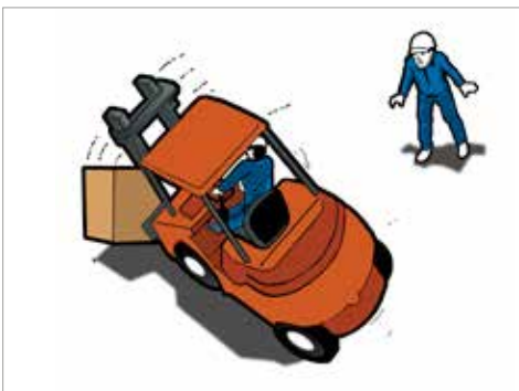
Figura 8. Perda do controlo do empilhador.
