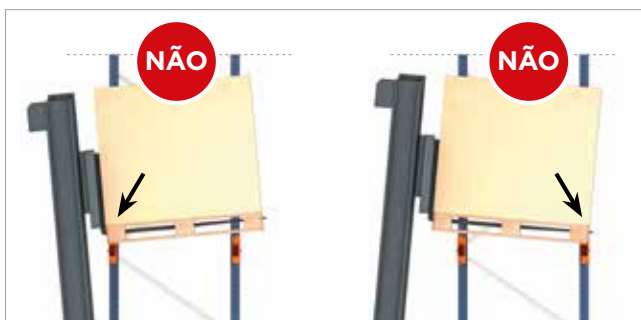
Figura 9. Sobrecarga sobre uma viga por descida não horizontal.
