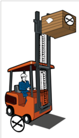
Figura 1. Não circular com cargas elevadas.
