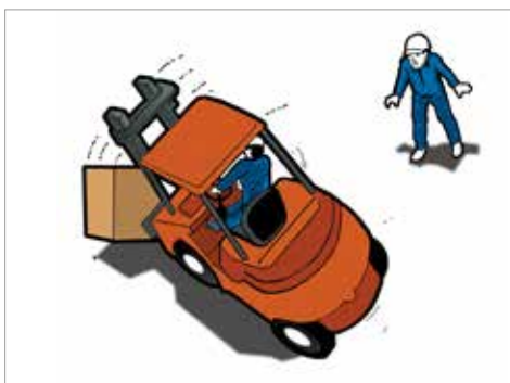
Figura 8. Perda do controlo do empilhador.
